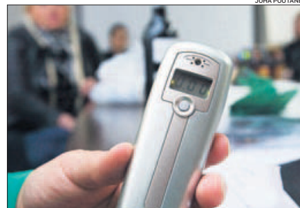
AL-2500:ssa ei ollut ollenkaan suukappaletta, vaan siinä puhallettiin kohti mittarin yläosaa.
