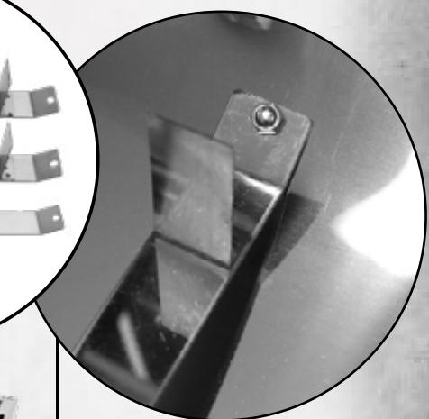
Fäst resistorbärarna med skruvar och kontramuttrar i nedre och övre delen. Fäst bärarna med spänplåtens bärare (1 och 2) i nedre delen. I övre delen fästs en bärare (3).
