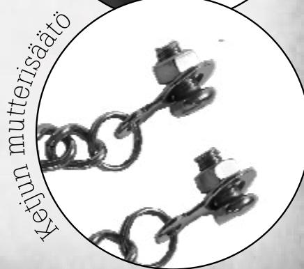
Kiinnitä ketju laitteen sivussa oleviin reikiin kannen ja rungon välille. Säädä ketjussa oleva mutteri niin, että ketju pääsee liikkumaan vapaasti ja kiinnitä ketju laitteen sisäpuolelta laippamutterilla kanteen sekä runkoon. Kiristä ruuvit jakoavaimella.
