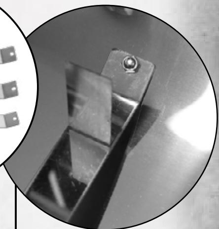
Kiinnitä vastuksen kannattimet ruuveilla ja vastamuttereilla laitteen runko-osaan sekä kanteen. Runko-osaan kiinnitetään kannakkeet, joissa on mukana purupellin kannattimet (1 ja 2). Kansiosaan kiinnityy yksi kannatin (3).
